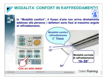
Nota che durante la funzione comfort, la velocità del ventilatore è fissata su automatico.
