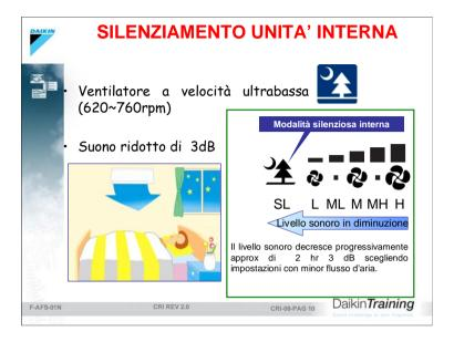
Azionando questa finzione si riduce la capacità di raffreddamento della macchina.
