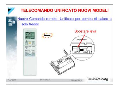
Modificando la posizione del microinterruttore, l'unità funzionerà come solo freddo o come pompa di calore.
